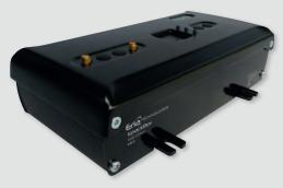
**Epack**Box permet de créer des architectures multiples en fonction des besoins et des systèmes déjà mis en place. Les données du véhicule sont collectées par le boitier télématique **Epack**Box via les interfaces disponibles et les protocoles adaptés.
